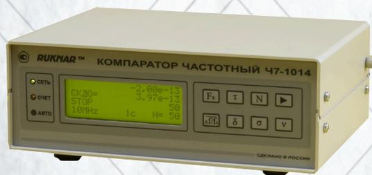
Компаратор частотный Ч7-1014 предназначен для измерения относительной разности частот прецизионных кварцевых генераторов и рубидиевых стандартов частоты, вычисления их основных метрологических характеристик с отображением процесса и результатов измерений на экране встроенного дисплея или внешнего ПК.
