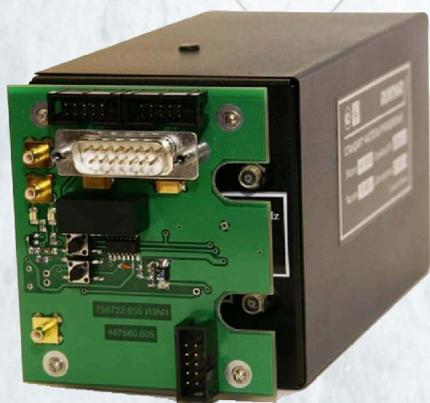
**Р**убидиевый стандарт частоты Ч1-1014 может поставляться совместно с платой приемника навигационных систем, которая предназначена для формирования сигнала секундной метки, используемого для корректировки частоты прибора.
